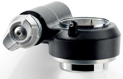
Die hydraulische Federvorspannung ZF PA ist direkt am Federbein integriert. Der Vorteil liegt darin, dass kein separates Handrad am Fahrzeug montiert werden muss. Speziell aktuelle Motorradmodelle bieten heutzutage kaum Platz für ein externes Handrad. Leicht zugänglich und ohne viel Kraftaufwand lässt sich die Federvorspannung um bis zu 15 mm justieren.
