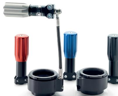
Unsere hydraulische Federvorspannung Wilbers PA ist die wohl komfortabelste Lösung die Federvorspannung zu justieren. Mittels des Handrades, welches mit einem fahrzeugspezifischen Halter am Motorrad befestigt wird, kann die Niveaulage für den Sozius- und/oder Gepäckbetrieb angeglichen werden. Der Verstellbereich beträgt 10 mm.
